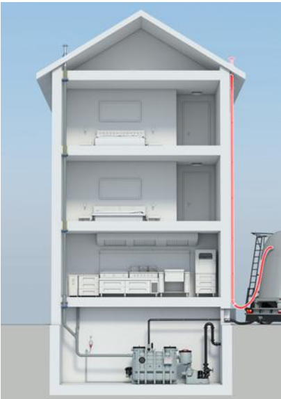
Separate Pendelgasleitung über Dach
