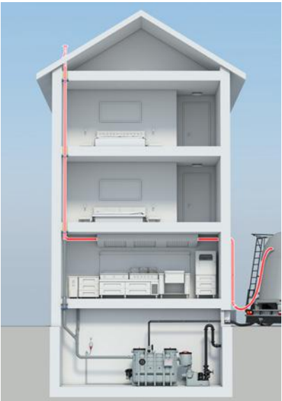
Pendelgasleitung angeschlossen an Lüftungsleitung des Fettabscheiders
