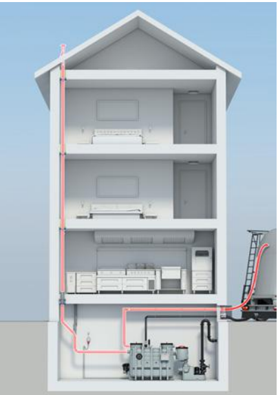
Pendelgasleitung angeschlossen an Fettabscheider
